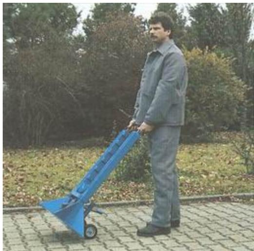
Los gatos de cremallera y los gatos hidráulicos pueden ser fácilmente desplazados sobre ruedas sólidas y posicionarse en la bobina.
