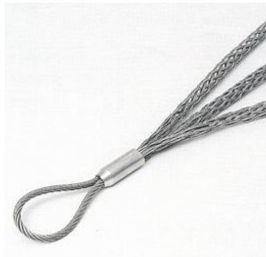
La malla tiracables estándar con el lazo sirve para los cables con un diámetro de 10 a 180 mm. La malla envuelve en arrastre de fuerza el cable en toda la longitud del trenzado. El manguito prensado, adaptado en dirección de tracción y los extremos trenzados contribuyen esencialmente a la seguridad.
