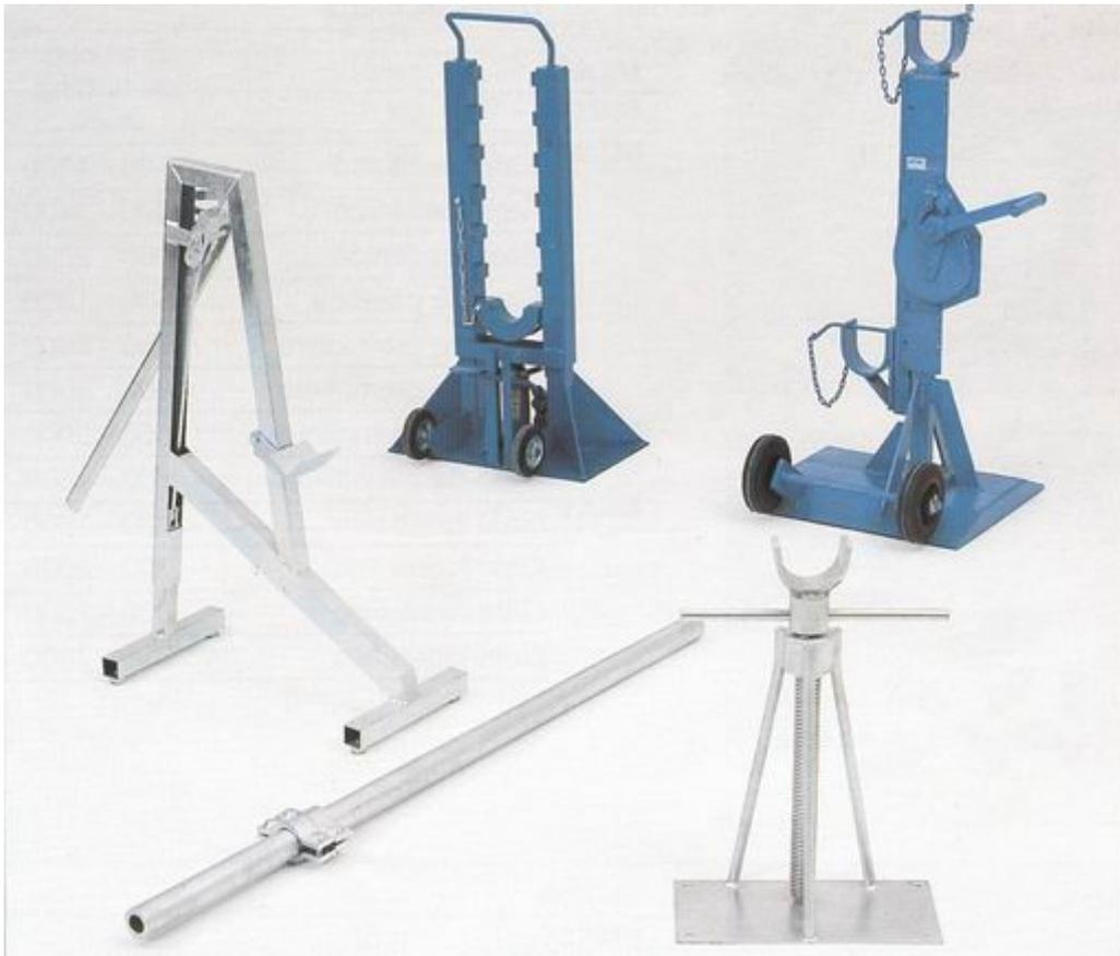
Los elevadores de bobinas de cable sólo pesan 13 kilogramos cada unidad. No obstante, con los mismos se pueden elevar bobinas de cable hasta de dos toneladas de peso. Se emplazan rápidamente hasta la bobina. Los dispositivos porta-ejes se colocan debajo del eje de la bobina a través de un mecanismo de retención de escalonado de precisión. A continuación, la bobina puede ser elevada hasta la altura de trabajo por medio de un movimiento de palanca.
