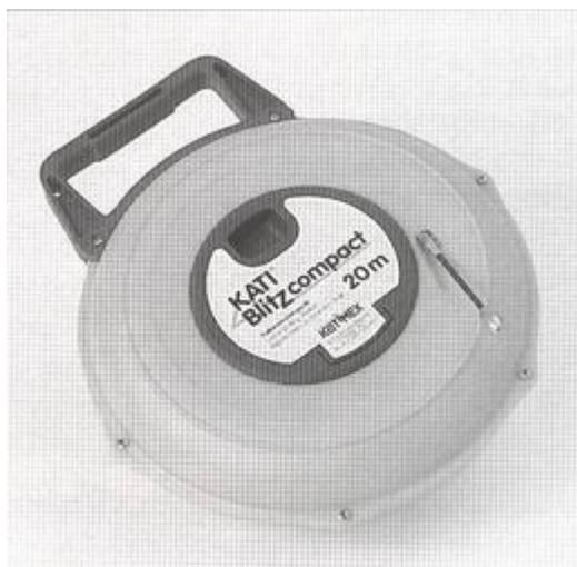
Dispositivo guía cables con cinta de vidrio Polykat Ø 3 mm. Modelo compact. Manguitos iniciales en ambos extremos, compartimento para accesorios en el centro del dispositivo. Con manillar
