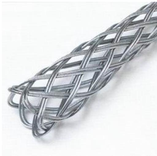
Al inicio de la malla se juntan todos los cables trenzados y se prensan en un manguito mediante un lazo de cable. El manguito de prensado lleva un amplio biselado en dirección de la tracción para impedir su enganche en el tubo. Gracias a los lazos flexibles, los cables se pueden introducir con más facilidad en tubos de diámetros pequeños.
