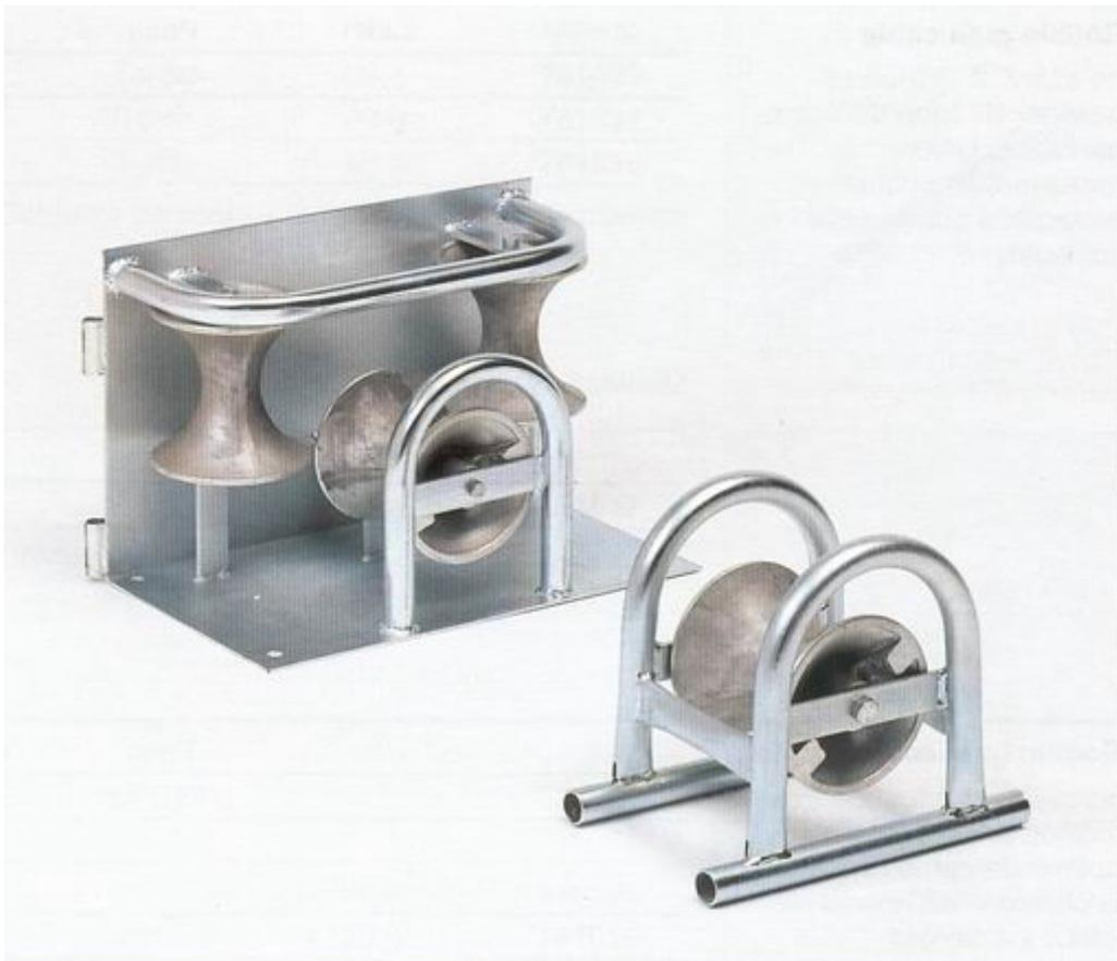
Gracias al tipo de construcción compacta, debajo de los rodillos queda suficiente espacio para cables ya tendidos. Debido al bajo punto de gravedad, los rodillos guía cables de tierra tienen una excelente estabilidad. Gracias a la característica moldura de los rodillos, la conducción lateral del cable es significativamente más estable en comparación con los rodillos de acero con moldura más pequeña.
