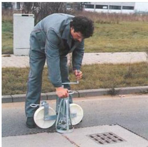
Los codos de introducción para pozos, el juego de rodillos de guía y la barra de fijación están compuestos de una construcción sólida de acero. Están completamente galvanizados y ofrecen, incluso con esfuerzos extremos, una larga duración. Los cuerpos de rodillos están compuestos de una aleación especial de aluminio y trabajan sin mantenimiento sobre rodamientos a bolas protegidos contra la suciedad y el polvo.
