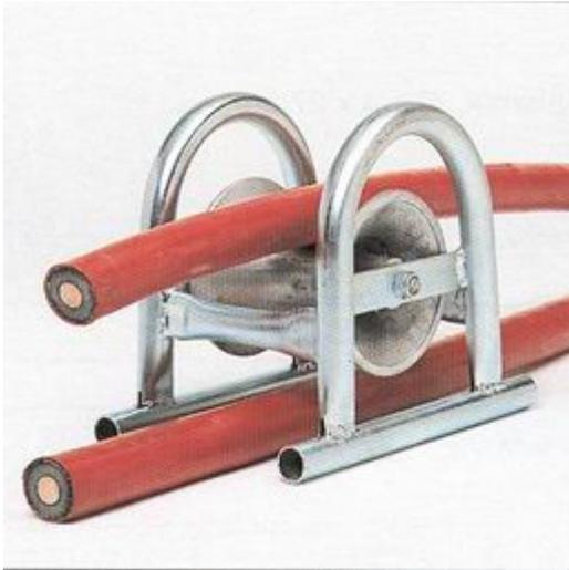
Los rodillos angulares conducen los cables con seguridad por toda la curva, reduciéndose la fricción del cable. Incluso cables pesados se desplazan con mayor facilidad sobre los cuerpos de los rodillos. Las fuerzas de tracción necesarias se reducen considerablemente y los cables de cabrestante ya no se desgastan tanto.
